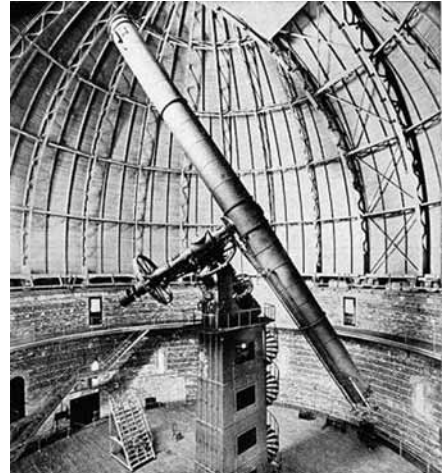
Abb. 7: Der Yerkes-Refraktor von 1897 (Objektivöffnung: 1,02 m, Brennweite 19,7 m) nahe Chicago/Wisconsin
