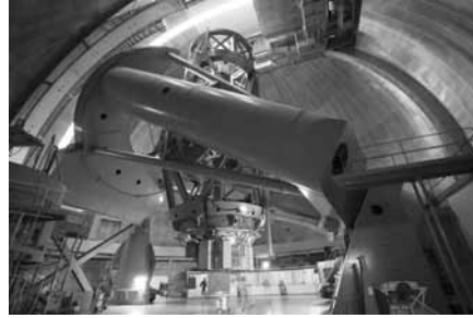
Abb. 10: Das 5 m Mount-Palomar-Teleskop von 1947 in seiner Montierung (Gesamtgewicht 450 t)
