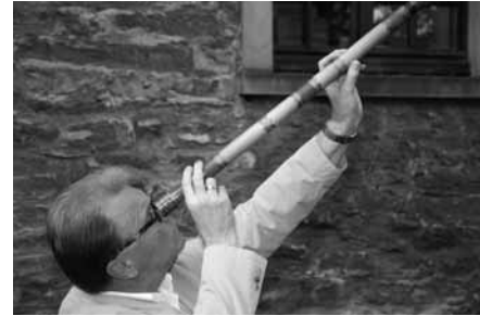
Abb. 1: Der Autor mit dem Nachbau eines von Galilei gegen Ende 1609 gebauten Prunkfernrohres (Öffnung: 2 cm)
