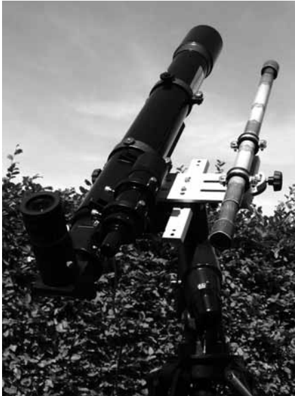
Abb. 2: 102 / 1.000 mm Refraktor (f 10) des Autors mit 8 x 50 Sucher, parallel dazu montiert das Galilei-Fernrohr Foto: H.-G. Pellengahr
