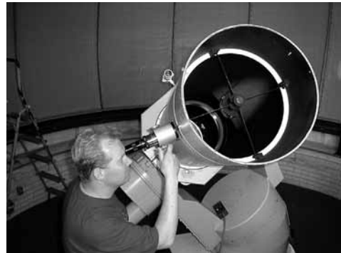
Das 16“ Newton / Cassegrain Remote-Teleskop, hier an seinem früheren Standort in der niederländischen Cosmos-Sterrenwacht Lattrop nahe Nordhorn (Foto: Campussternwarte)
