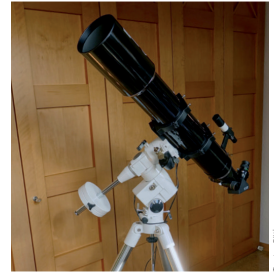
Gut: das Stativ ist solide, die Montierung trägt ein nicht zu großes Teleskop.
