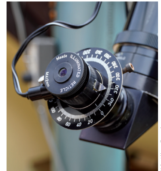
Selbstgebaute Skala für ein Okular zur Winkelmessung von Doppelsternen.
