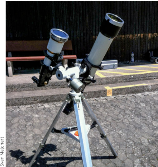
Zwei Teleskope auf einer kleinen Montierung und zu leichtem Stativ sind nicht stabil genug.
