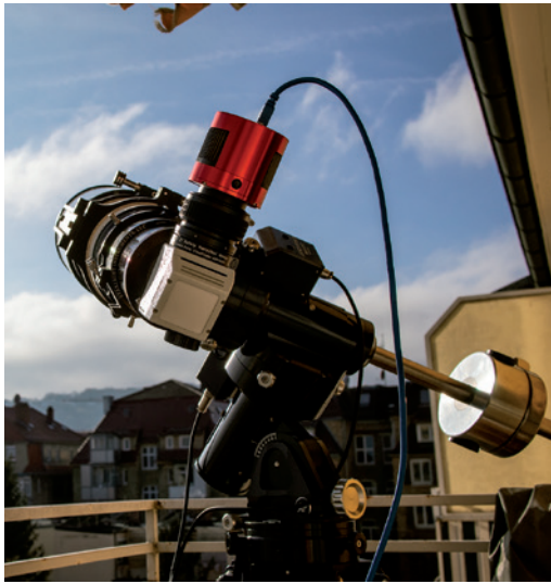
Teleskop mit Herschelkeil (weißer Kasten)
